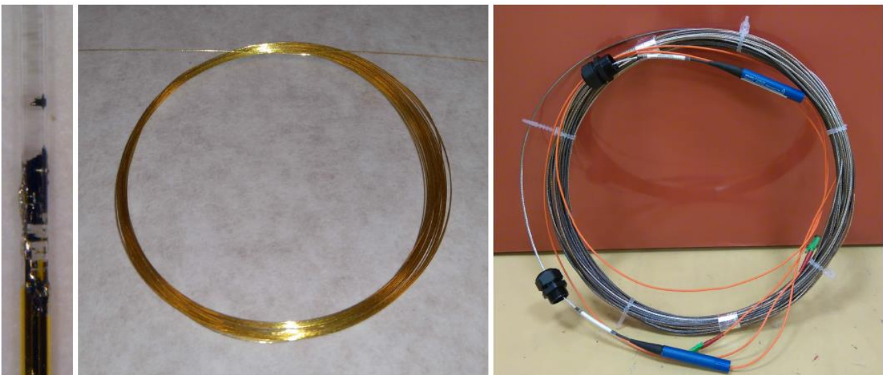
Figure 43 : Fibre à revêtement or partiellement dénudée (gauche), avec revêtement (milieu) et insérée dans la protection FIMT et connectisée (droite) [EDF2]
