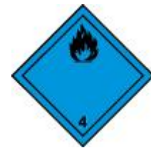
Dégage du gaz inflammable au contact de l'eau
